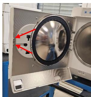
Nach der Türöffnung die zwei Sicherungen unten rechts auswechseln, welche sich oberhalb vom Ein- und Ausschalter befinden. Die neuen Sicherungen sind auf der linken Innenseite der Türe.
