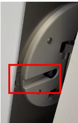
In diesem markierten Bereich muss der Nottüröffner eingeführt werden.
